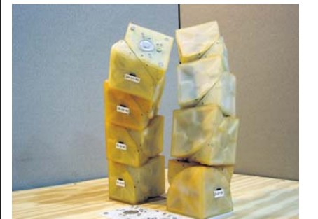
Les « molécubes », très agiles, sont composés de 4 cubes articulés. DR
